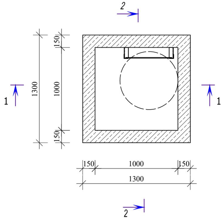
**Узел прохода трубы через стены**
